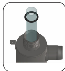
Fig. 4. Instalación de la Funda de Cuarzo
