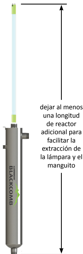
Fig. 2. Espacio para reemplazar la lámpara
