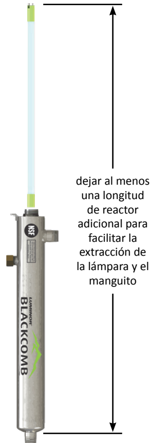
Fig. 2. Espacio para reemplazar la lámpara
