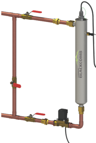
Fig. 3. Montaje del Bypass
